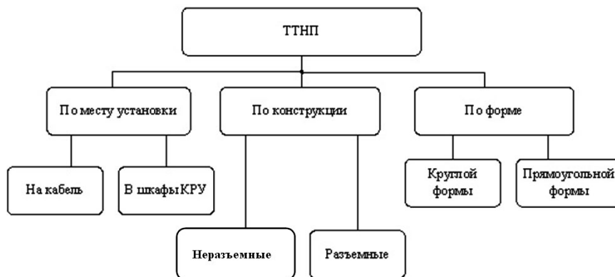
Рис. 1. Классификация трансформаторов тока нулевой последовательности
