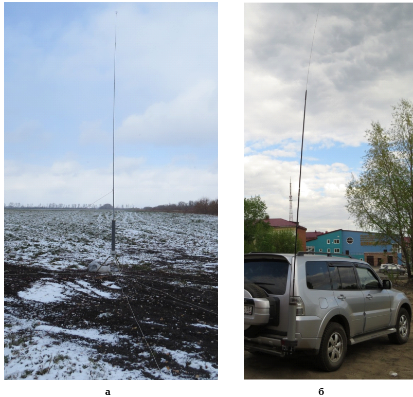
Рис. 5. Вариант размещения малогабаритных антенн на земле (а) и на автомобиле (б)
