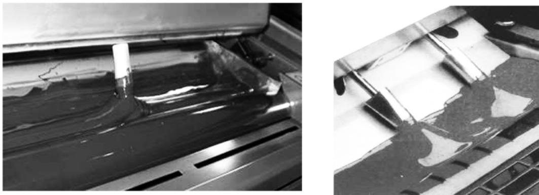
Рис. 1. Автоматические мешалки краски: стержневая (слева), коническая (справа)
