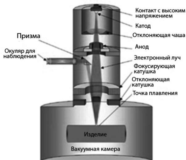
Рис. 9. Принципиальная схема работы устройства по технологии EBM
