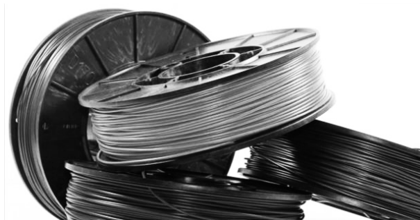
Рис. 3. Катушки с исходным материалом для FDM-метода
