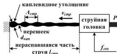
Рис. 3. Образование каплевидных утолщений в струе СОЖ (пирометр не показан)
