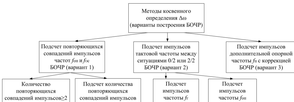
Рис. 2. Классификация методов косвенного определения ошибки по угловой скорости
