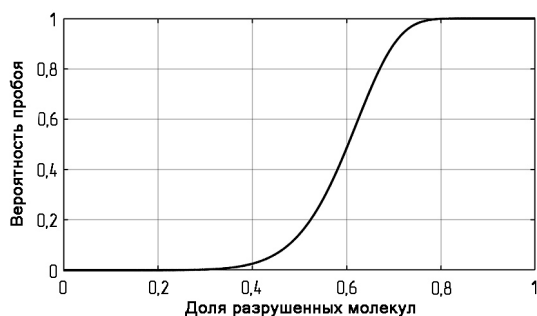
Рис. 3. Зависимость вероятности пробоя от доли разрушенных молекул
