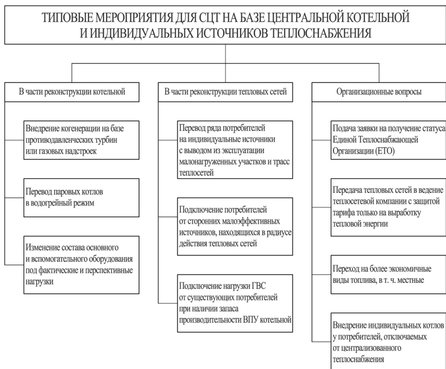
Рис. 2. Типовые мероприятия, предлагаемые к внедрению в СЦТ на базе центральной котельной и индивидуальных источников теплоснабжения
