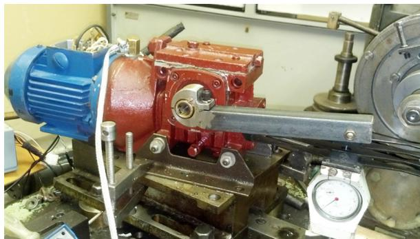
Рис. 1. Лабораторный стенд для прогнозирования остаточного ресурса работы электромеханического оборудования
