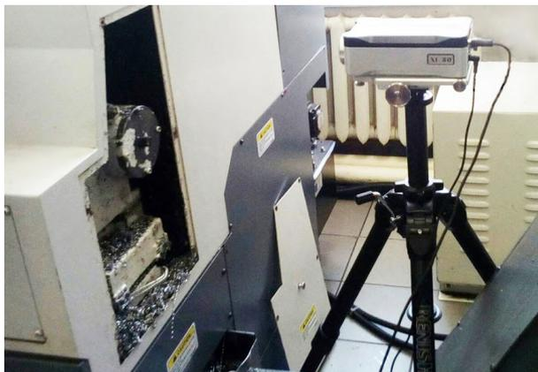
Рис. 2. Фотография установки оптики для юстировки вдоль оси Z
