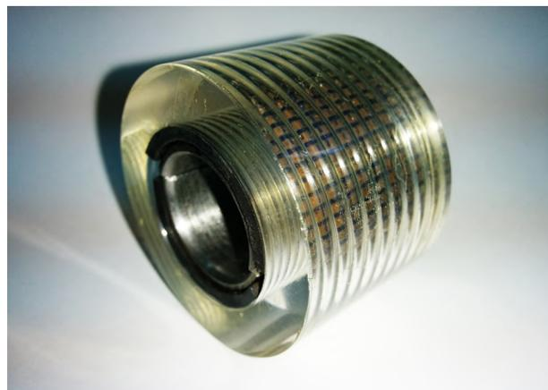
Рис. 6. Цилиндрическая модель РМК с волнистой поверхностью матрицы
