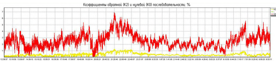
Рис. 4. Временные диаграммы несимметричных фазных напряжений (а) и коэффициентов несимметрии напряжений по обратной и нулевой последовательности (б)
