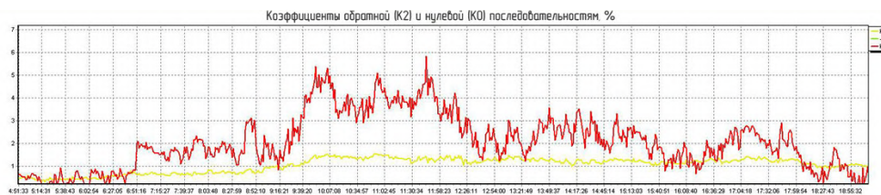
Рис. 3. Временная диаграмма токов (а) и коэффициентов несимметрии напряжений по обратной и нулевой последовательности (б) фидера 0,4 кВ, питающего учреждение бюджетной сферы
