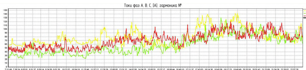
Рис. 2. Временная диаграмма несимметричных фазных токов ВРУ 0,4 кВ жилого дома
