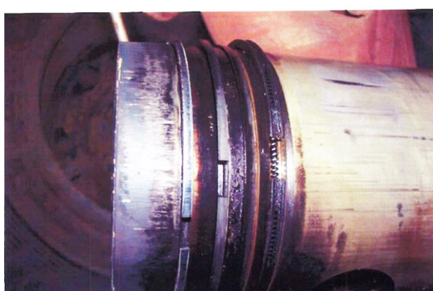
Рис. 4. Повреждение поршня при использовании высокосернистого топлива
