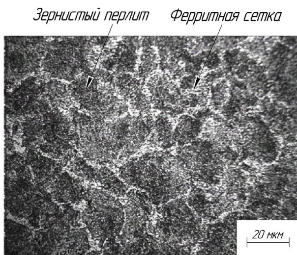
Рис. 3. Сталь 30ХГСА в состоянии поставки
