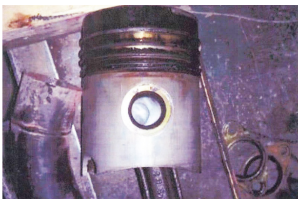
Рис. 3. Закоксовывание поршневых колец двигателя
