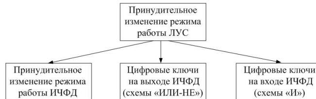
Рис. 2. Варианты способов принудительного изменения режима работы ЛУС
