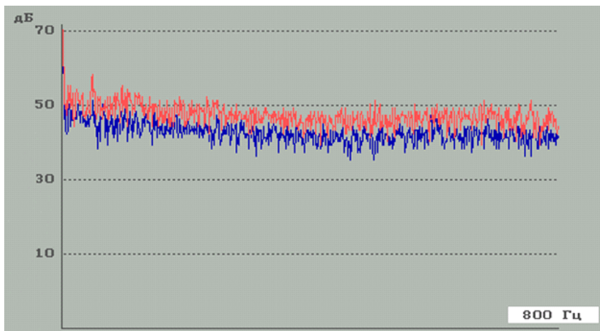
Рис. 4. Спектры огибающей сигнала виброускорения: серийный П1 — верхний спектр частот, обработанный П2 — нижний спектр частот
