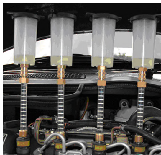
Рис. 5. Контроль технического состояния клапанов управления по объему сливаемого топлива из штуцера форсунки
