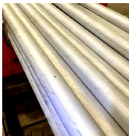
Рис. 8. Качество поверхности осветлённых труб
