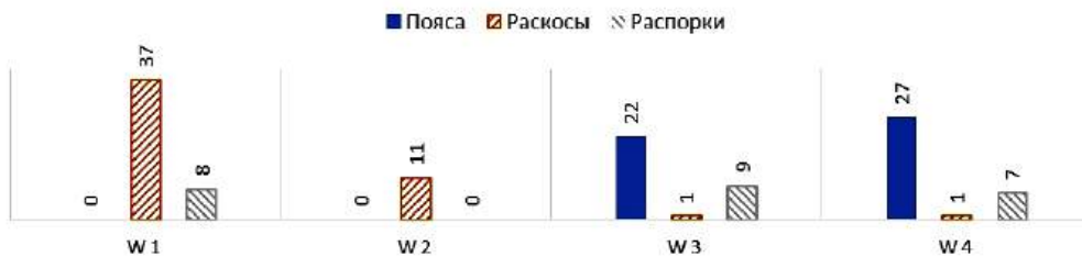
Рис. 4. Распределение количества элементов конструкции, для которых определенное направление ветра (W1, W2, W3, W4) является расчётным Fig. 4. Distribution of the number of structural elements for which a certain wind direction (W1, W2, W3, W4) is calculated
