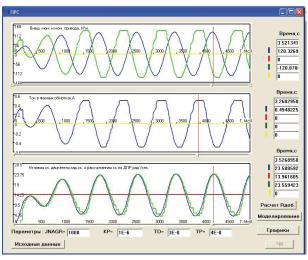
Рис. 6. Переходные процессы при Мвн. = SIN и Jн. = 1,0·10<sup>3</sup> кг·м<sup>2</sup>
