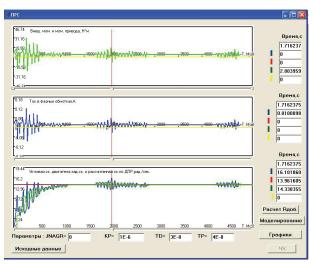
Рис. 1. Переходные процессы при Мвн. = 0,0 Н·м
