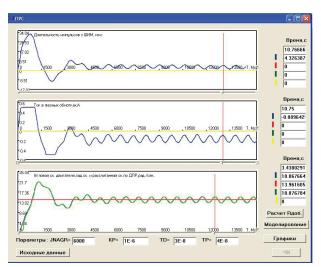
Рис. 5. Переходные процессы при Мвн. = Exp + SIN и Јн. =  $6,0\cdot10^3~{
