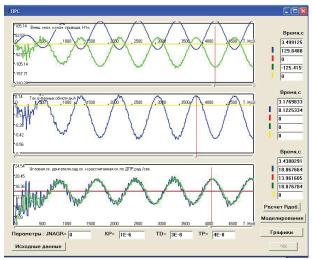
Рис. 4. Переходные процессы при Мвн. = Exp + SIN и Јн. =  $0.0~{\rm Kr}{\rm M}^2$
