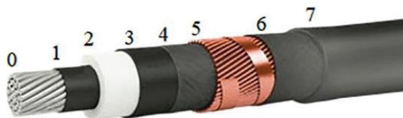
**Рис. 2.** Строение кабеля АПВП: 0 — алюминиевая жила; 1 — экран по жиле; 2 — изоляция; 3 — экран по изоляции; 4, 6 — кабельная бумага; 5 — медный экран; 7 — оболочка кабеля
