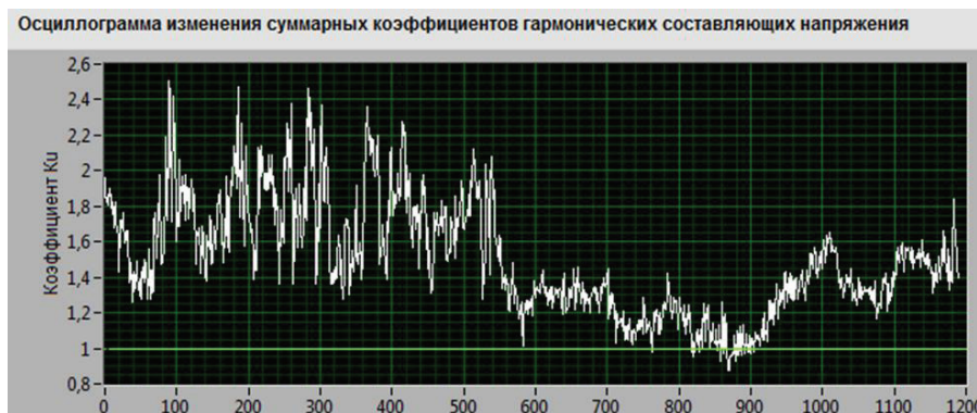
Рис. 2. Осциллограммы изменения суммарных коэффициентов гармонической составляющей напряжения на линиях КИО-3
