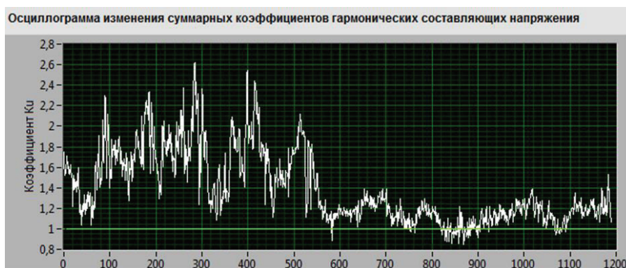
Рис. 3. Осциллограммы изменения суммарных коэффициентов гармонической составляющей напряжения на линиях КИО-4
