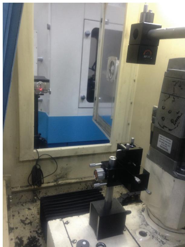
Рис. 2. Наладка на измерение точности позиционирования вдоль вертикальной оси Y
