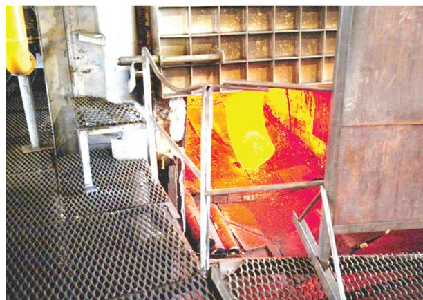
Рис. 2. Печь для протяжки отводов
