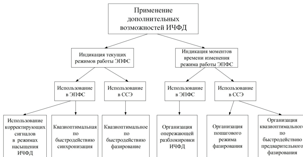
Рис. 4. Классификация вариантов применения импульсного частотно-фазового дискриминатора с расширенными функциональными возможностями
