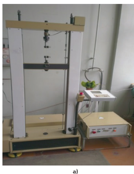
Рис. 3. Прочностные испытания образцов пленки: разрывная машина 2166 P-5 (а), схема крепления образца пленки при испытаниях на разрыв (б)
