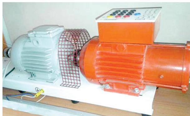
**Рис. 2.** Электромашинный агрегат с АДКЗ и АДФР
