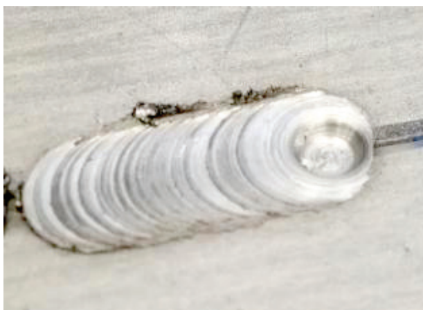
Рис. 7. Сварной шов сплава ВТ-1-0, полученный с использованием улучшенной конструкции приспособления для подачи защитного газа
