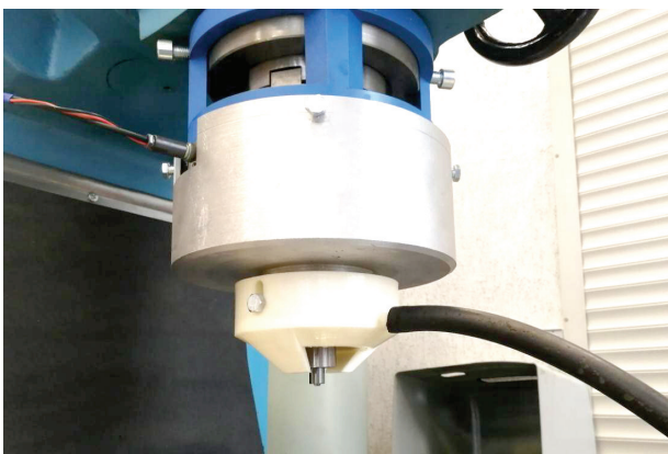
Рис. 4. Установка для сварки трением с перемешиванием титановых сплавов с приспособлением для подачи защитного газа
