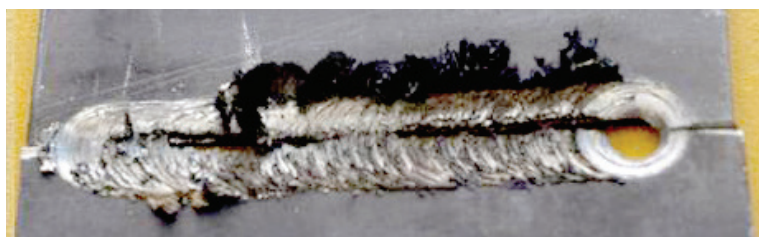
Рис. 2. Образец, полученный с использованием струйной подачи защитного газа [10]
