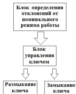
Рис. 6. Структурная схема блока управления
