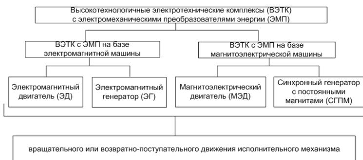
Рис. 2. Структурная схема ВЭТК с электромеханическим преобразователем
