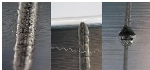
Рис. 5. Результаты обработки инструментом, заточенным классическим способом
