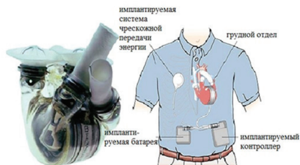
Рис. 3. Реализация чрескожной передачи энергии для устройства AbioCor компании ABIOMED [6]
