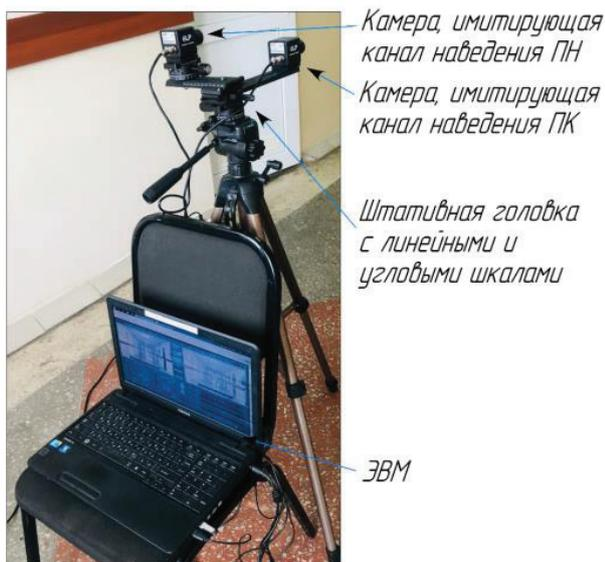
Рис. 3. Внешний вид экспериментальной установки
