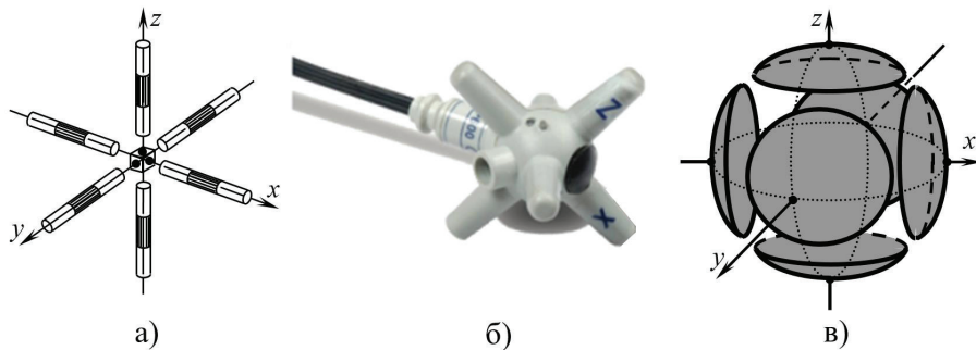
Рис. 3. Трехкоординатные электроиндукционные датчики напряженности электрического поля разомкнутого типа: а) и б) — с чувствительными элементами цилиндрической формы; в) — с чувствительными элементами сферической формы
