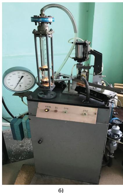
Рис. 7. Испытательный стенд: а) схема: 1 — влагоотделитель, 2 — вентиль, 3 — манометр образцовый, 4 — регулятор давления, 5 — ротаметр, 6 — вентиль, 7 — манометр, 8 — пневмакамера, 9 — педаль для распределения; б) общий вид
