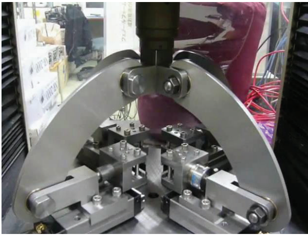
Рис. 8. Рычажный механизм для создания двухосного нагружения фирмы Zwick
