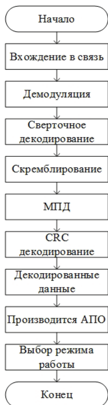
Рис. 2. Блок-схема приема и декодирования входного сигнала на БРТК
