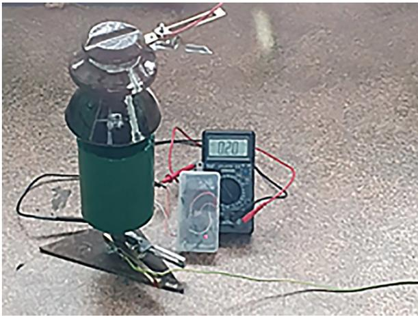
Рис. 4. Рабочее состояние диагностического устройства при поврежденном изоляторе
