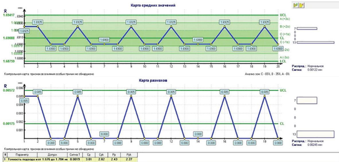
Рис. 6. Контрольные карты размахов и средних значений показаний трехкоординатного индикатора при выполнении одностороннего подвода к боковой поверхности зубьев
