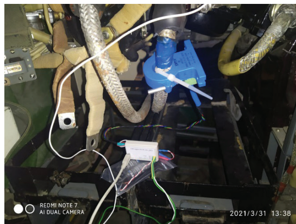
Рис. 4. Подключение АВLogger в бортовую сеть машины
