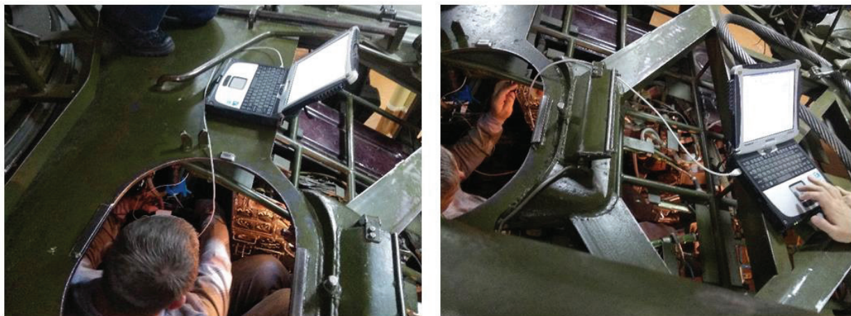
Рис. 5. Снятие характеристик бортовой сети при включении потребителей и передача их на ПЭВМ
