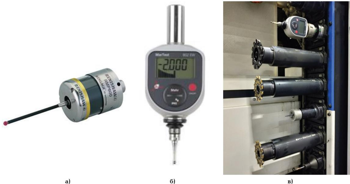
Рис. 4. Средства контактных измерений: а) контактный датчик Renishaw; б) трехкоординатный индикатор MarTest 802 EW; в) щуп в инструментальном магазине станка
