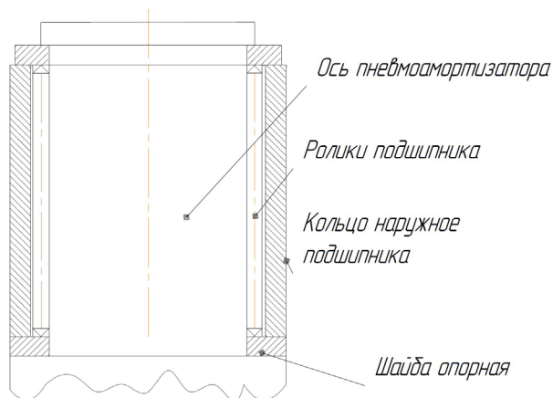
Рис. 5. Предлагаемая конструкция оси амортизатора в сборе с подшипником
