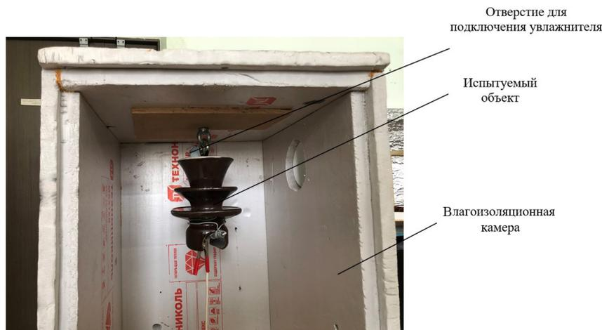
Рис. 6. Влагоизоляционная камера
