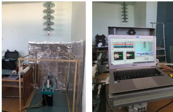
Рис. 2. Внешний вид лабораторного стенда и лицевая панель программного обеспечения (LabView)
