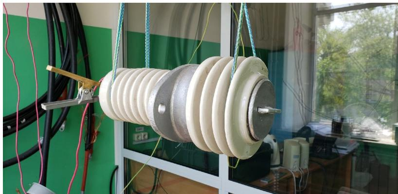
Рис. 4. Испытательный образец проходного изолятора после шлифовки острых краев
