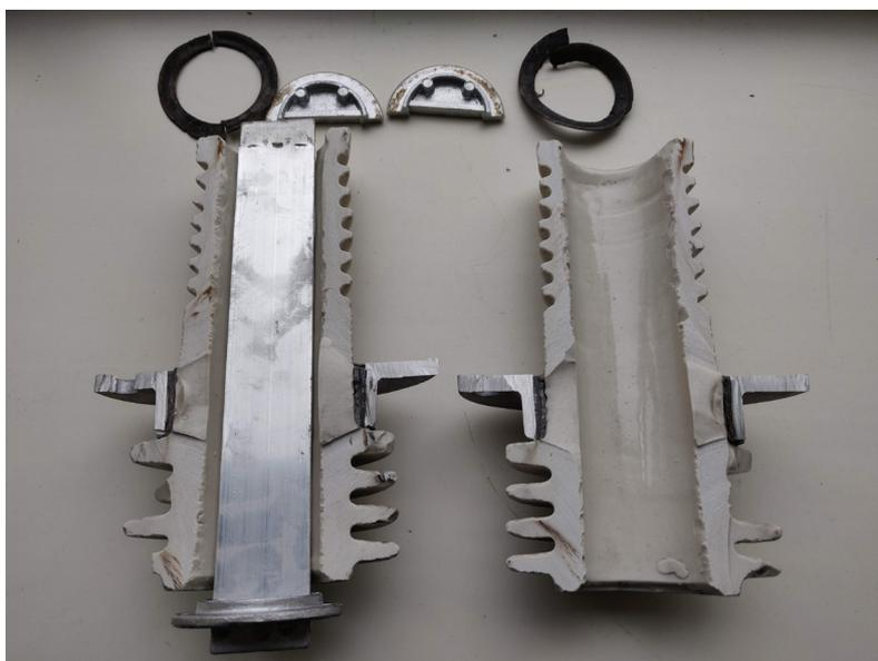
Рис. 8. Образец ввода после разрушения для локализации дефектов
