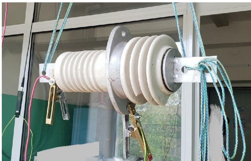
Рис. 2. Экспериментальный образец проходного изолятора
