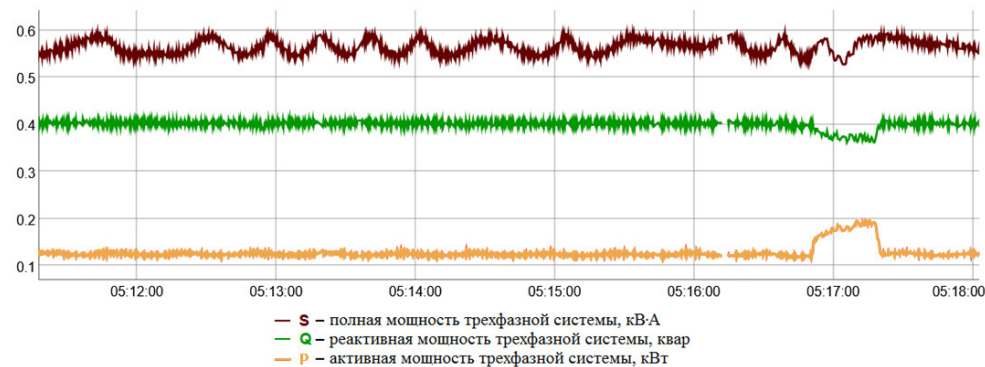
Рис. 3. Осциллограммы параметров мощности трехфазной системы
