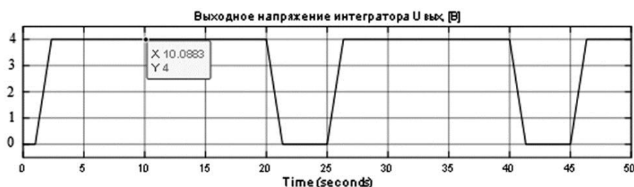
Рис. 3. Диаграмма выходного напряжения интегратора
