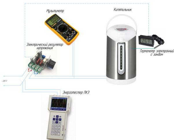
Рис. 5. Схема электрическая структурная
