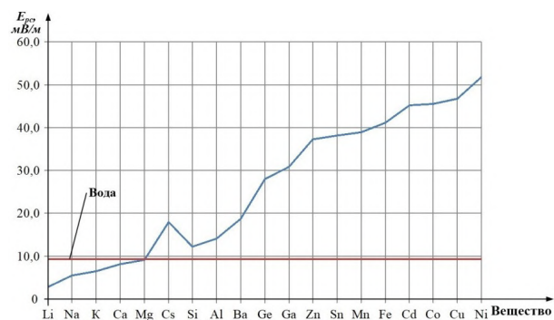
Рис. 6. Зависимость разрешающей способности E_{pc} для разных веществ (металлов и полупроводников) с плотностью до 10000 \text{ кг/м}^3 и температурой плавления до 1600 \text{ }^\circ\text{C}
