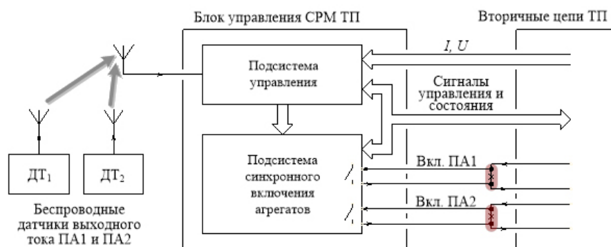
Рис. 1. Структурная схема разработанной системы резервирования мощности тяговой подстанции
