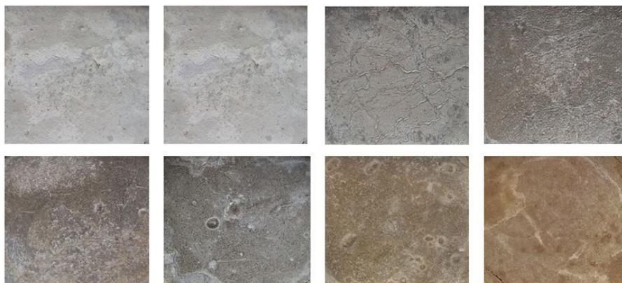
Рис. 2. Изображения поверхности бетонных образцов с различным содержанием  $FeCl_3$
