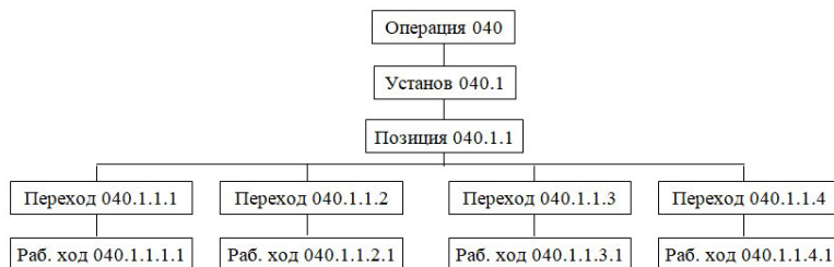
Рис. 3. Технологическая структура круглошлифовальной операции обработки опорных элементов корпуса подшипника распревала
