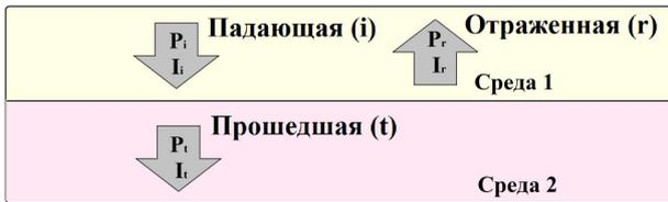
Рис. 1. Схема передачи (прохождения и отражения) ультразвуковой волны
