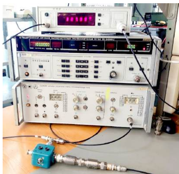
Рис. 4. Используемые приборы при измерении фазоамплитудной погрешности Fig. 4. Devices used to measure phase-amplitude error
