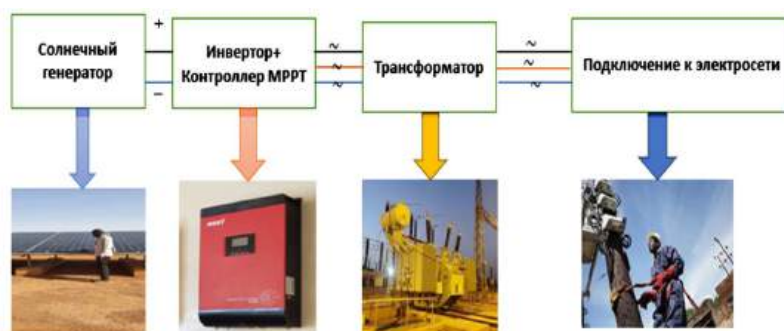
Рис. 4. Упрощенная структура солнечной фотоэлектрической установки без накопителя, подключенной к электрической сети Fig. 4. Simplified structure of a solar PV installation without storage, connected to the grid, used directly during the day
