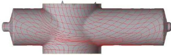
Рис. 6. QForm модель с исходными данными: диаметр заготовки 25 мм, компенсатор цилиндрический
