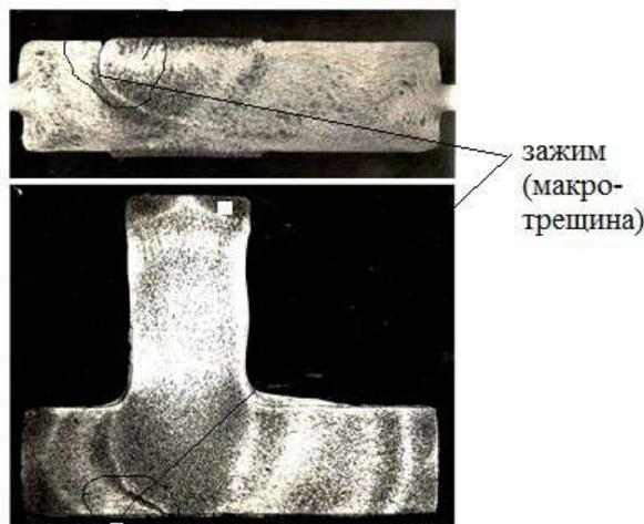
Рис. 4. Макроструктура «Тройника 122»
