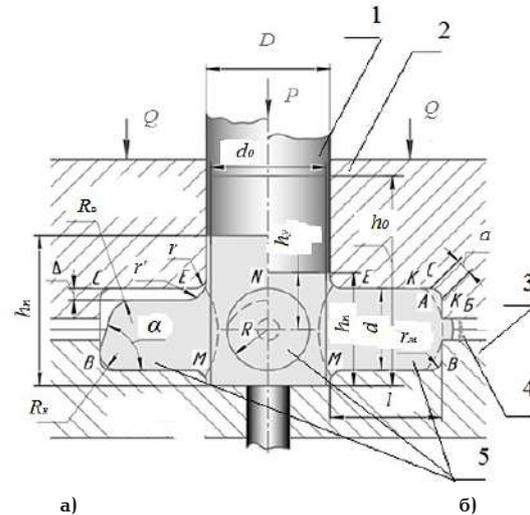
**Рис. 1.** Схема заполнения матрицы при штамповке поковки с отростками [3]: а — стадия истечения в боковую полость; б — стадия заполнения боковой полости. 1 — пуансон; 2 — полуматрица верхняя с приемником; 3 — полуматрица нижняя; 4 — компенсатор; 5 — полости под боковые отростки
