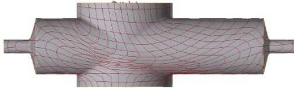
Рис. 7. QForm модель с исходными данными: диаметр заготовки 27 мм, компенсатор цилиндрический
